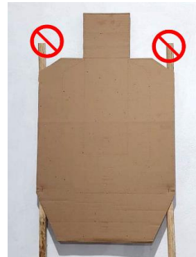
Os sarrafos devem ser cortados para não aparecerem acima do Alvo
